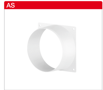
■ Anschluss-Stutzen AS Mit quadratischer Flanschplatte (102 x 102 mm) und rundem Stutzen (50 mm lang), aus Kunststoff. Zum Aufsetzen von Rohren (ND 100) auf plane Flächen.
